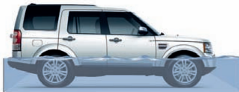
Wading Depth Maximum wading depth 700mm Normal wading depth 600mm
