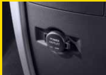
12 volt power outlet
