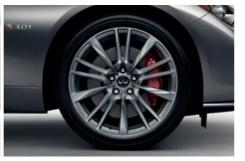
19X8.5-INCH ALUMINIUM-ALLOY WHEELS WITH RED BRAKE CALLIPERS. STANDARD ON Q50 RED SPORT MODELS.
